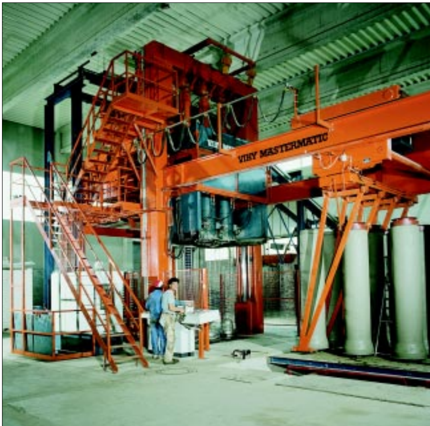
Fulldautomatisk betonrørsanlæg fra Pedershaab A/S. Pedershaab A/S er verdens største leverandør af betonrørsmaskiner. Der er i alt beskæftiget 800 personer i betonmaskinindustrien her i landet. Industrien er en af de nicher, hvor Danmark har en førende position på verdensmarkedet. Det er vigtigt for landets økonomi at der er områder, hvor danske virksomheder er specielt gode.
