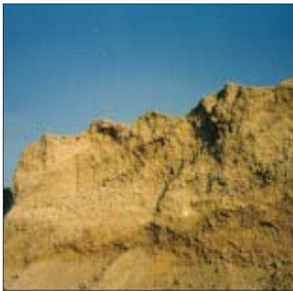
Depot med knuste betonrør. Restcement binder den knuste beton sammen.
