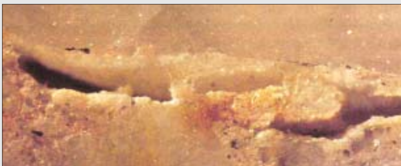
Revneblokada af \text{CaCO}_3 krystaller (Kalciumkarbonatudfældninger). Revnevidde 0,2 mm. Foto af tyndslib.
