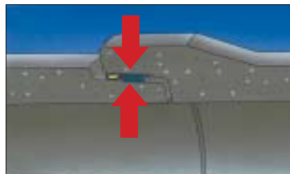
Ved måling af diameteren på rørets spidsende og muffe kan kompressionen på gummipakningen beregnes og vurderes i forhold til kravene.
