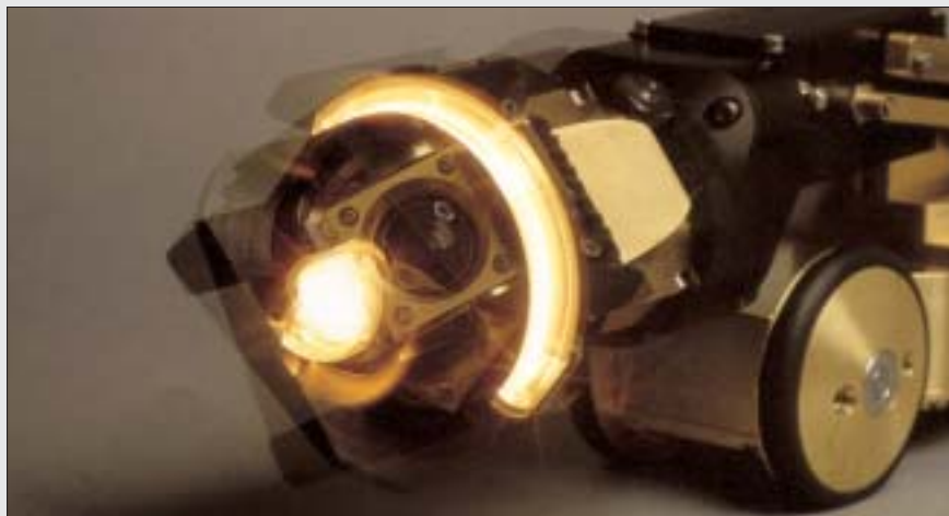
De højtudviklede kameraer er med til at sikre en effektiv kontrol af de lagte ledninger.
