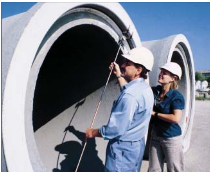
Betonafløbskomponenters samlingsmål kontrolleres med måleværktøjer, som måler med 1/10 mm's nøjagtighed.
