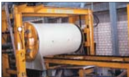
Rørene tæthedsprøves i specialudviklede prøvestande.
